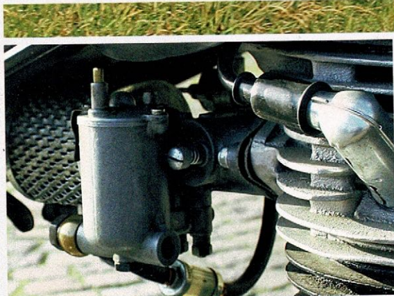
Im Original befütterte ein Vergaser des VEB Berliner Vergaser- und Filterwerke (BVF) den 350er-Motor
